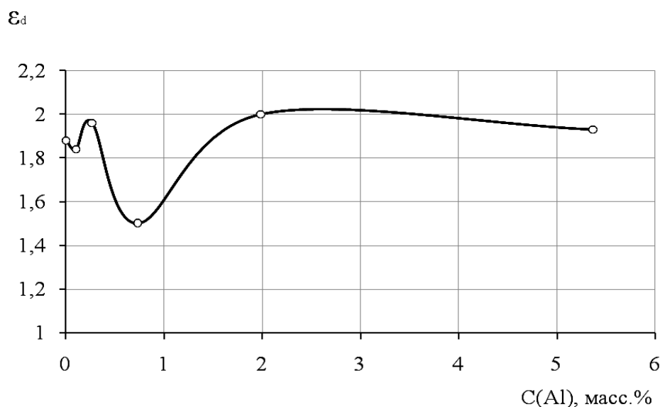
Рис. 7. Зависимости диэлектрической проницаемости для композитов на основе 80 масс. % СКИ-3 + 20 масс. % ПЭНП от концентрации частиц (Al)
