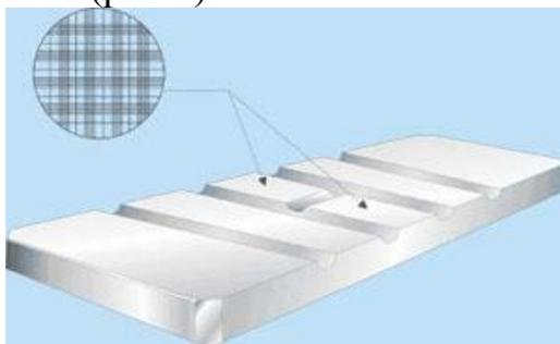
Рис. 1. Камера Горяева - это приспособление предназначенное для подсчета количества клеток в заданном объеме жидкости.
