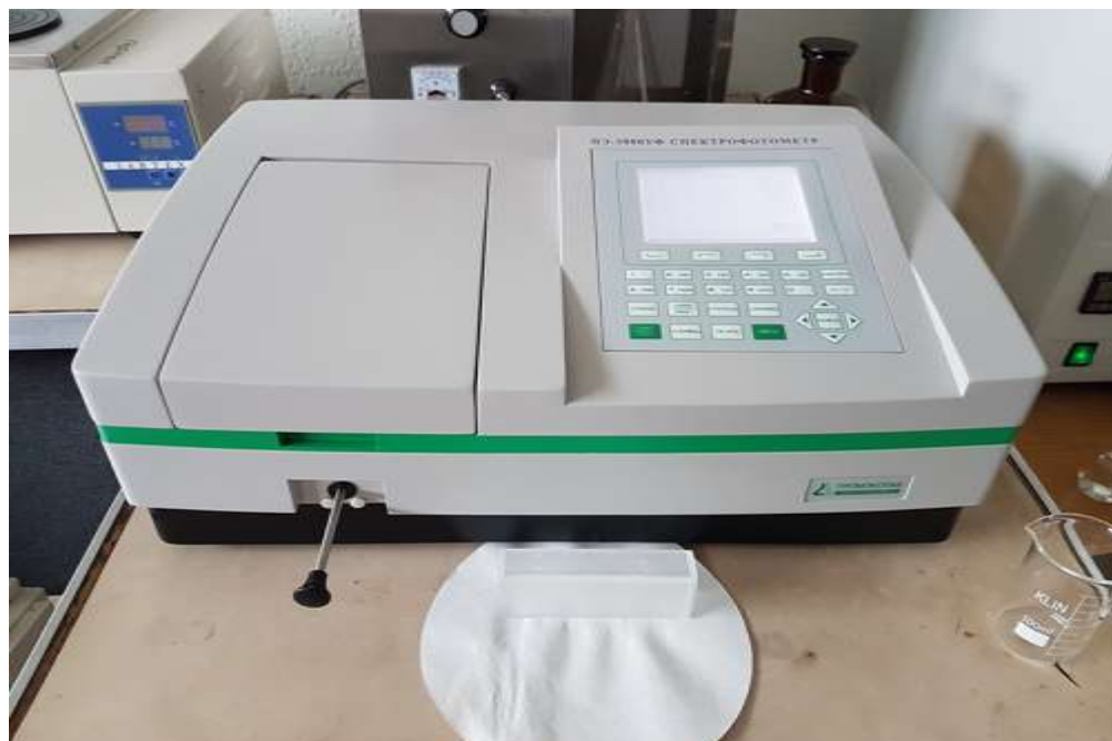
Спектрофотометр (ПЭ-3000УФ), со спектральным диапазоном 190-1100 нм
