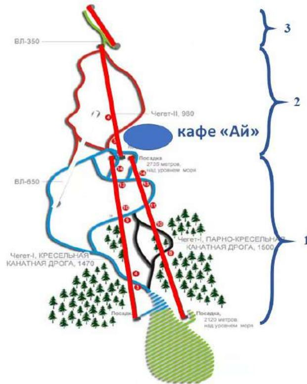
Вторая очередь (ККД «Чегет-2») представлена однокресельной канатной дорогой длиной 900 м и перепадом высот около 500 м, идущей от кафе «Ай» до метеостанции. 3-я очередь в верхней части – бугельный подъемник (так называемый «Шагобан») длиной приблизительно 150 м, перепад высот которого составляет около 50 м.
