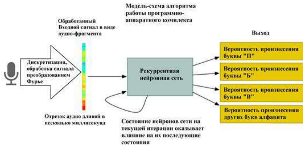
Рисунок. Схема распознавания речи рекуррентной нейронной сетью
