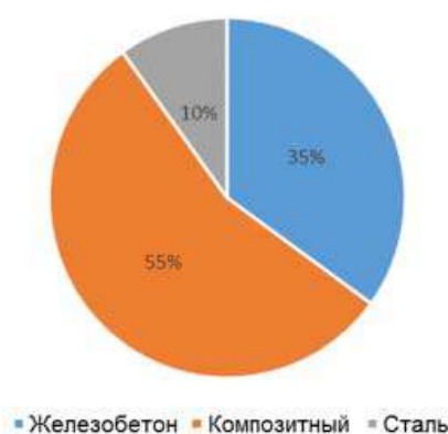
Рис. 2. Диаграмма использования материалов для зданий высотой до 300 м
