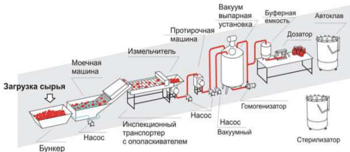
Рис. 2. Технологическая линия производства томатной пасты на базе установки «Ротофильм»
