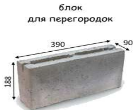
Рис. 3. Размеры перегородочного пеплоблока
