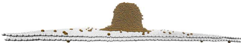
Рис. 1. Наноразмерная капля галлия на поверхности ДГ. Время проведения компьютерного эксперимента \tau = 0.1 мкс
