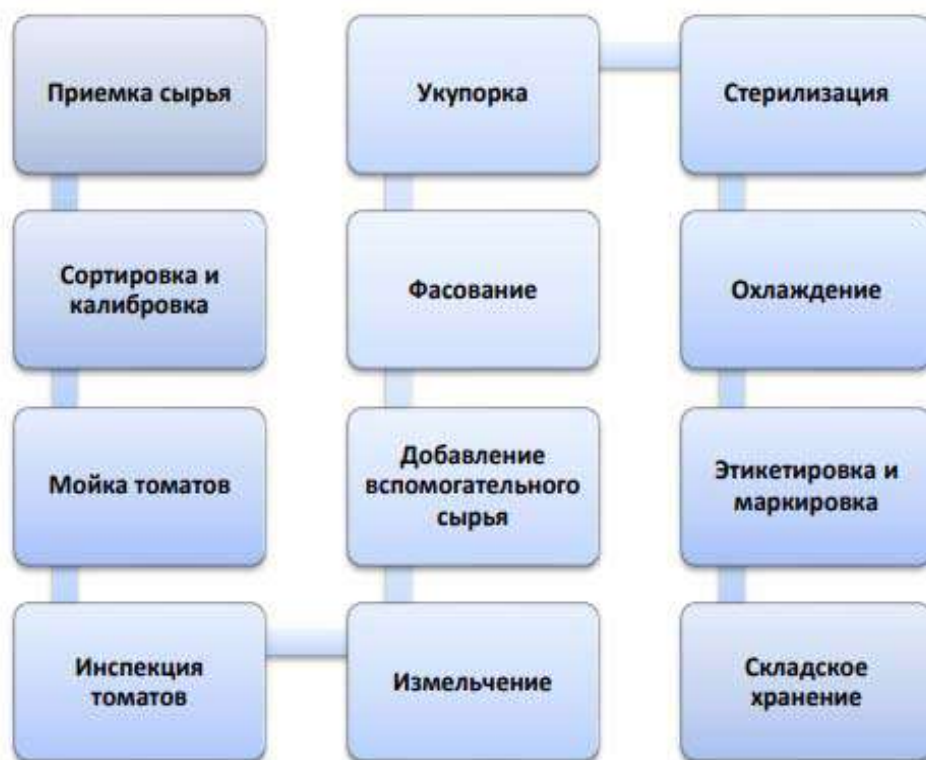
Рис. 1. Блок-схема производственного процесса томатной пасты на ООО «Зеленая компания»
