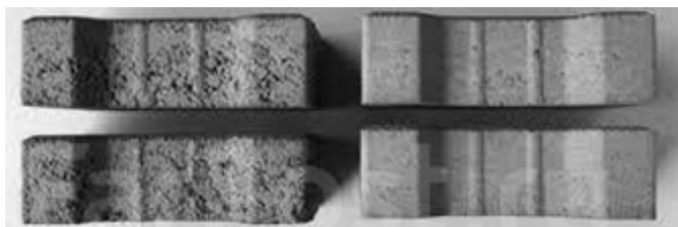
Рис. 2. Бетон без добавления пластификатора и с добавлением
