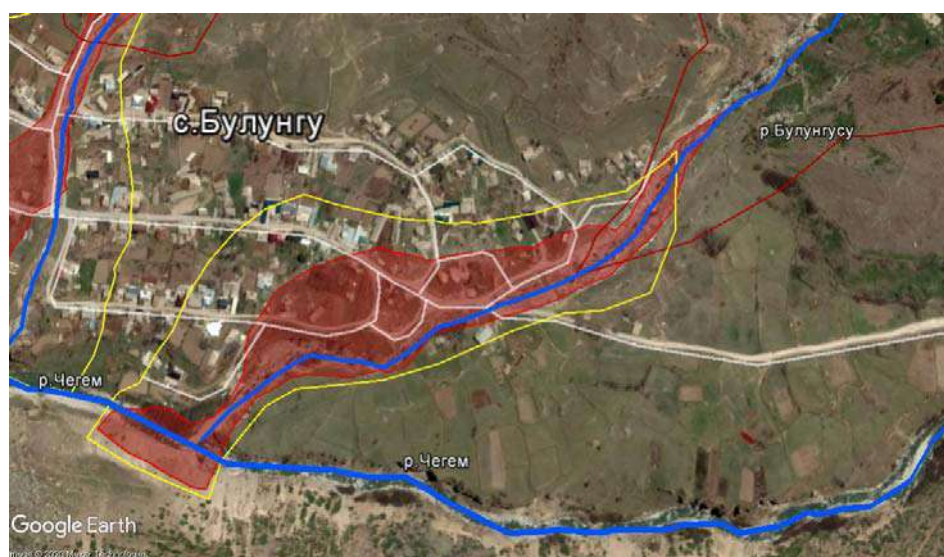
Рисунок. Схема расположения зон поражения н.п. Булунгу селями р. Булунгусу: красным цветом выделена актуальная зона поражения, желтым – зона возможного поражения. Космоснимок Google Earth
