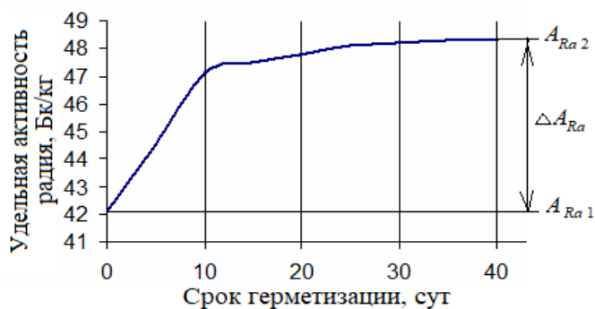
Рисунок. Определение коэффициента эманирования угольного аргиллита
