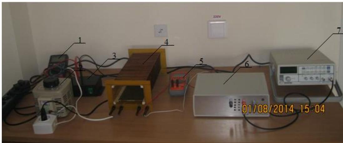
Рис. 2 Устройство для создания переменного магнитного и электрического полей
