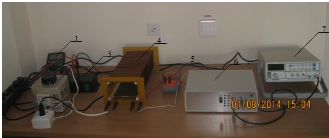
Рис. 2 Устройство для создания переменного магнитного и электрического полей 1 – вольтметр переменного напряжения; 2 – автотрансформатор; 3 – высоковольтный источник переменного напряжения; 4 – соленоид со встроенными металлическими пластинами; 5 – амперметр переменного тока; 6 – реостат регулировки тока (встроен в усилитель); 7 – генератор низкочастотный.
