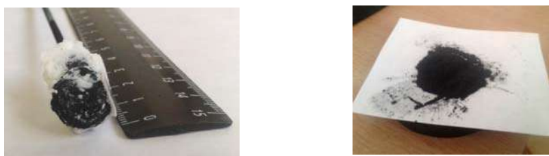
Рис. 3. Металло-солевая груша и отмытый порошок, состоящий из смеси интерметаллических фаз \text{Ho}_x\text{Ni}_y
