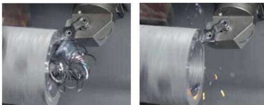
Рис. 1. Сравнение обработки инструментом без стружколома и обработки инструментом с стружколомом
