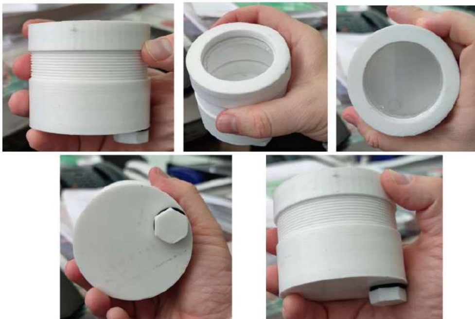
Рис. 1.– Сцинтиляционная ячейка, напечатанная на 3D-принтере. Объем ~ 73 см 3
