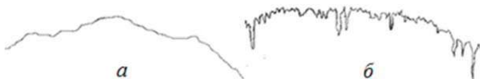
Рис. 1. Микрорельеф поверхности природного алмаза: а) в исходном состоянии, б) после снятия хромового покрытия
