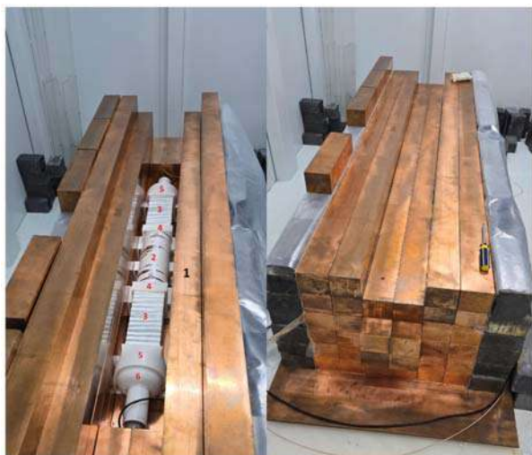
Рис. 3. Расположение детектора внутри низкофоновой защиты.
