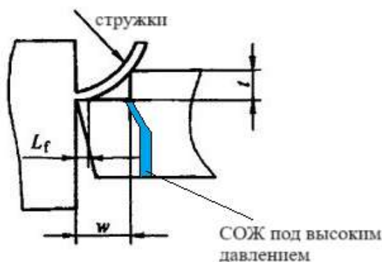
Рис. 3. Воздействие струи охлаждающей жидкости под высоким давлением приводит к разворачиванию стружки
