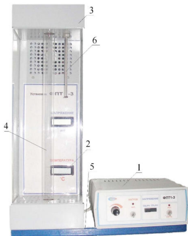
Рисунок 1 - Общий вид экспериментальной установки: 1 - блок приборов; 2 - цифровой термометр; 3 - блок рабочего элемента, 4 - вольфрамовая проволока; 5 - стойка; 6 - датчик температуры (термопара).
