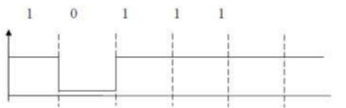
Рис. 1. Пример потенциального кода NRZ
