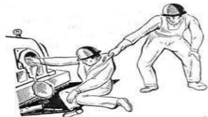
Рис. 3. Освобождение пострадавшего от действия части, находящейся под напряжением до 1000 В
